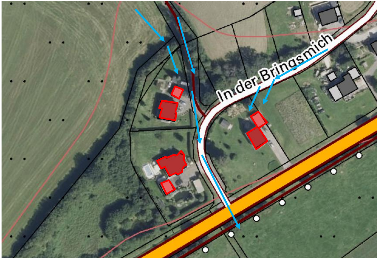
Abbildung 64: besonders betroffenen Objekte (rot markiert) und Fließwege (blaue Pfeile) bei der Tiefenlinie „Bringsmich“
