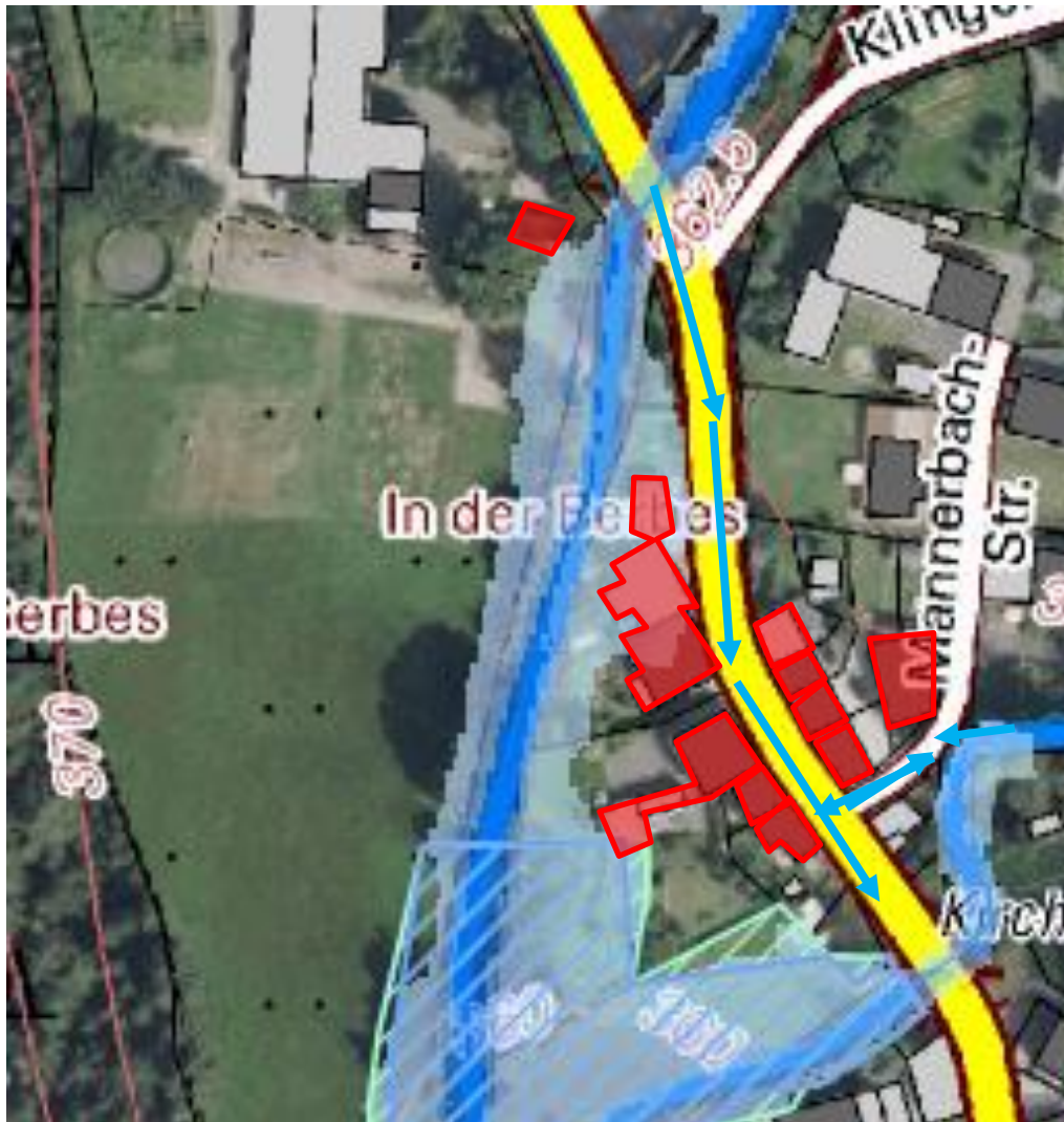
Abbildung 31: besonders gefährdete Objekte (rot) und zusätzlicher Abfluss (blaue Pfeile) in der Irsentalstraße
